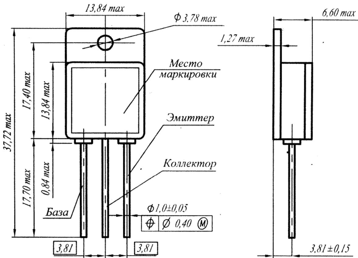
Разрешается укорачивать вывода. При этом расстояние от корпуса до места пайки должно быть не менее 5 мм.
